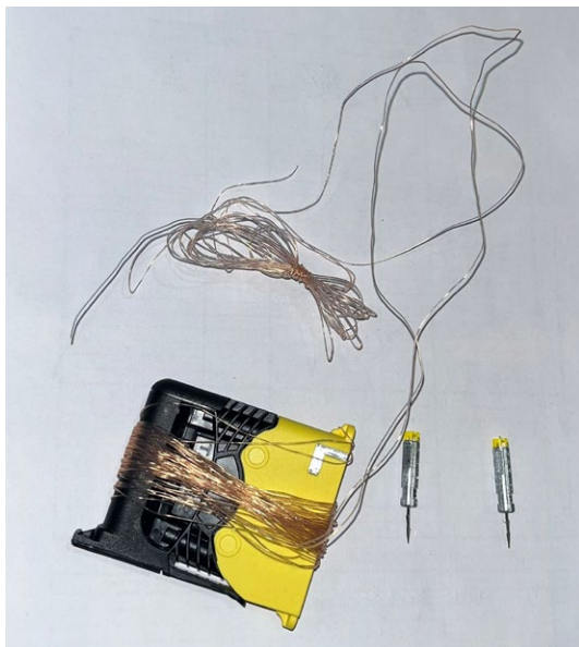
Fot. 11–12. Obudowa kartridża z przewodami wraz z dwiema sondami z haczykami.
