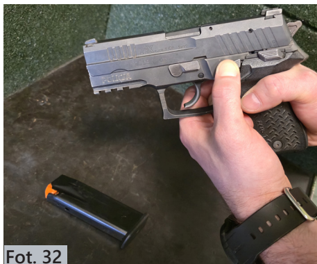
Fot. 32. Odłączenie magazynka i sprawdzenie, czy ponowne naciśnięcie na zatrzask zamka spowoduje bezpieczne zwolnienie kurka będącego uprzednio w pozycji napiętej oraz czy spust powrócił do przedniej pozycji w trybie samonapinania.
