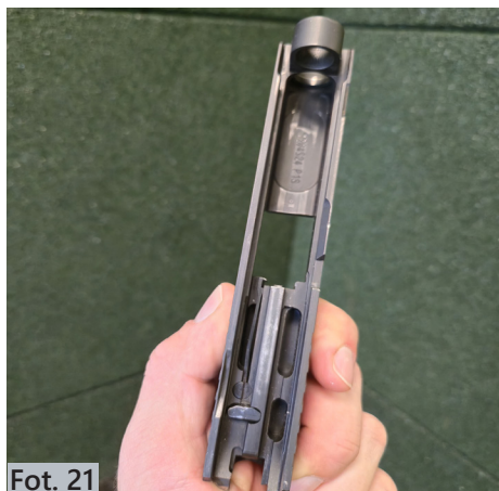
Fot. 21. Widok wewnętrznej strony zamka po usunięciu nadmiaru osadu prochowego oraz zabrudzeń.
