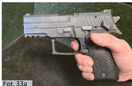
Fot. 33a–33b. Sprawdzenie poprawności działania bezpiecznika manualnego przy zwolnionym kurku. Włączenie bezpiecznika poprzez podniesienie jego dźwigni i ściągnięcie spustu (broń zabezpieczona). Sprawdzenie, czy spust rusza się swobodnie podczas ściągania i powraca do przedniej pozycji w trybie samonapinania po puszczeniu. Sprawdzenie, czy kurek pozostaje zwolniony (samonapinanie wyłączone).
