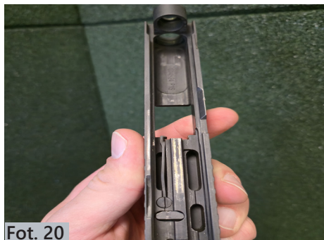
Fot. 20. Sprawdzenie, czy po wewnętrznej stronie zamka nie ma nadmiaru osadu prochowego oraz zabrudzeń. Uwaga – na zdjęciu widoczne zabrudzenia wewnętrznej strony zamka.
