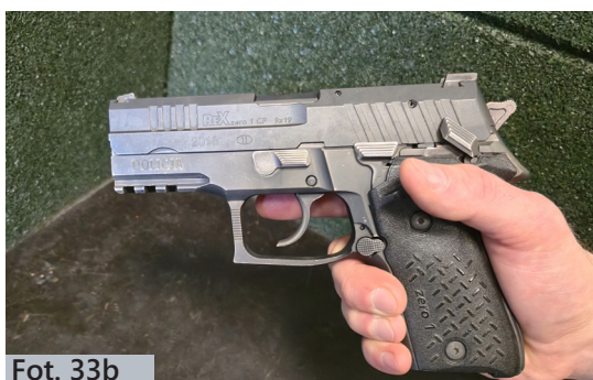
Fot. 33a–33b. Sprawdzenie poprawności działania bezpiecznika manualnego przy zwolnionym kurku. Włączenie bezpiecznika poprzez podniesienie jego dźwigni i ściągnięcie spustu (broń zabezpieczona). Sprawdzenie, czy spust rusza się swobodnie podczas ściągania i powraca do przedniej pozycji w trybie samonapinania po puszczeniu. Sprawdzenie, czy kurek pozostaje zwolniony (samonapinanie wyłączone).
