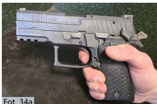
Fot. 34a–34b. Sprawdzenie poprawności działania bezpiecznika manualnego przy napiętym kurku. Napięcie kurka ręcznie lub przez odciągnięcie zamka. Włączenie bezpiecznika i ściągnięcie spustu. Sprawdzenie, czy spust porusza się swobodnie podczas ściągania i powraca do pozycji w trybie bez samonapinania po puszczeniu. Sprawdzenie, czy kurek pozostaje napięty (samonapinanie wyłączone) 6 .
