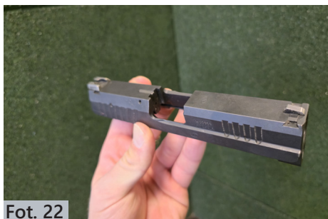
Fot. 22. Sprawdzenie, czy nie ma śladów korozji na zamku. Widok zamka bez śladów korozji.
