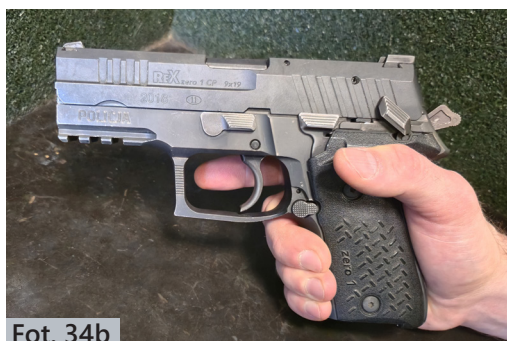
Fot. 34a–34b. Sprawdzenie poprawności działania bezpiecznika manualnego przy napiętym kurku. Napięcie kurka ręcznie lub przez odciągnięcie zamka. Włączenie bezpiecznika i ściągnięcie spustu. Sprawdzenie, czy spust porusza się swobodnie podczas ściągania i powraca do pozycji w trybie bez samonapinania po puszczeniu. Sprawdzenie, czy kurek pozostaje napięty (samonapinanie wyłączone) 6 .
