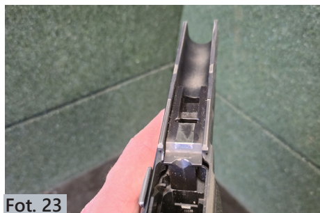
Fot. 23. Sprawdzenie, czy nie ma osadu prochowego oraz zabrudzeń po wewnętrznej stronie szkieletu. Uwaga – na zdjęciu widoczne zabrudzenia.
