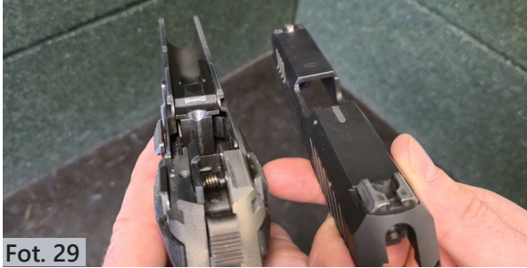
Fot. 29. Zamek i szkielet pistoletu bez widocznych pęknięć, odłupań, wgnieceń.
