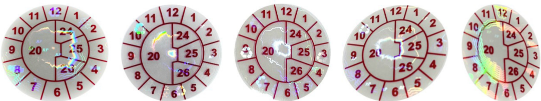
Fot. 2. Widok nalepki na tablice tymczasowe pod różnymi kątami.
