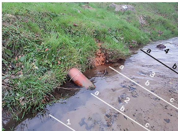
Ryc. 7. Profile badawcze uwzględniające możliwość pojawienia się zanieczyszczeń z elementów nieznanego pochodzenia znajdujących się w linii brzegowej rzeki. Zdj. B. Wojtasik, opracowanie własne.
