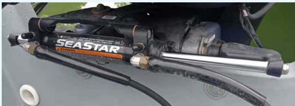
● Ryc. nr 63. Sterociąg hydrauliczny do silników zaburtowych. Powyższy sterociąg zawiera zestaw: pompę HH5271-3, siłownik HC5345-3, przewody od 4 do 7,5 m. Fot. P. Konstantynowicz.
