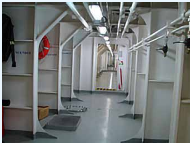
● Ryc. nr 45. Przejście przez gródź wyposażoną w drzwi wodoszczelne.
