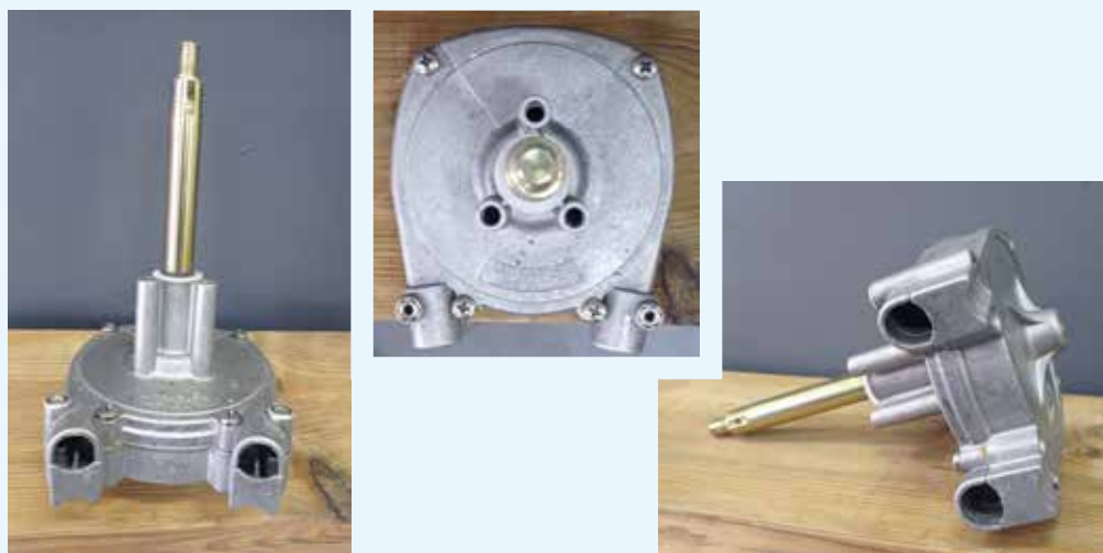
● Ryc. nr 64. Przekładnia kierownicza w 3 rzutach. Fot. P. Konstantynowicz.
