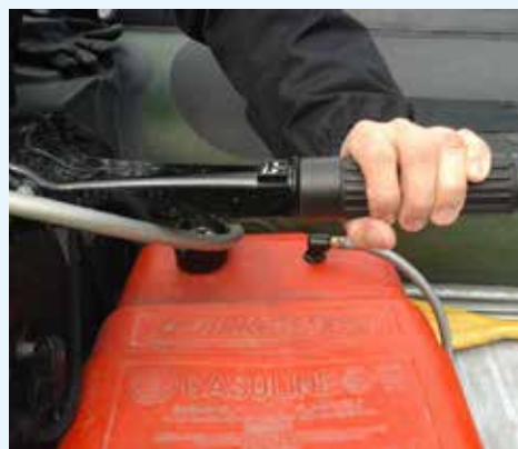
● Ryc. nr 58. Rumpel w silniku zaburtowym spalinowym. Fot. P. Konstantynowicz.
