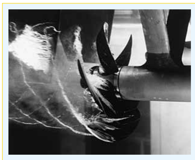
● Ryc. nr 130. Kawitacja wokół śruby, eksperyment w tunelu wodnym.
