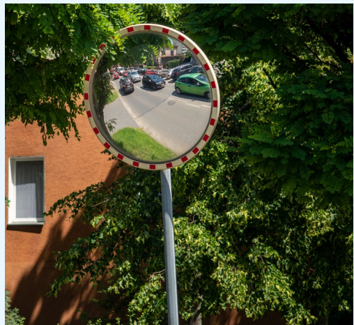
Fot. 13. Zastosowanie lustra drogowego wypukłego U-18a.
