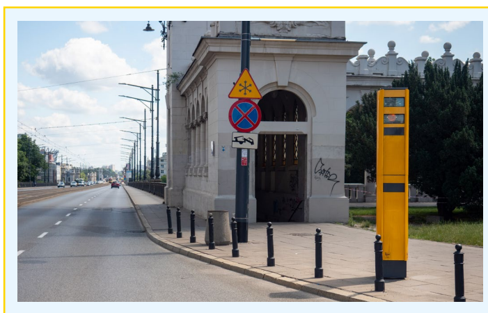
Fot. 18. Stacjonarne urządzenie rejestrujące z obudową typu wieżowego.
