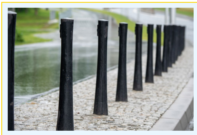
Fot. 9. Słupki blokujące U-12c w formie ozdobnej i barwie dostosowanej do architektury otoczenia.
