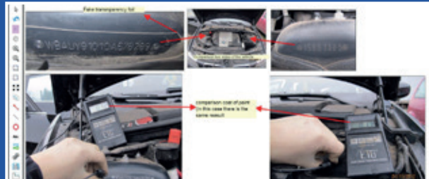
Bezinwazyjne badanie powłoki lakierniczej w pojeździe przy użyciu miernika powłok lakierniczych. Źródło: W. Ceglarski, FAVI – zanim się zalogujesz... , „Kwartalnik Policyjny” 2017, nr 1, s. 26.
