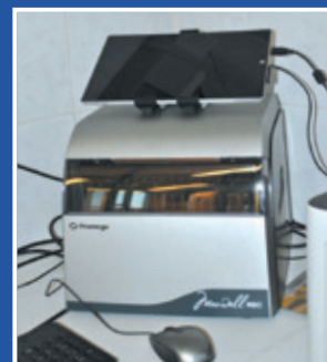
Automat „Maxwell” firmy Promega służący do izolacji DNA metodą magnetyczną. Źródło: P. Pucółowski, P. Sokalski, H. Wodzicki, Ł. Wiśniewski, Wyposażenie LK KSP w sprzęt do badań kryminalistycznych , „Kwartalnik Policyjny” 2017, nr 1, s. 11.
