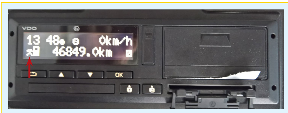
Fot. 11. Ustawienie aktywności „inna praca”.
