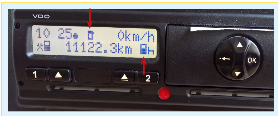
Fot. 23. Prawidłowe zalogowanie karty kontrolnej – wcześniejszy model VDO.
