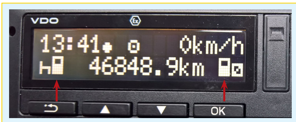
Fot. 3. Piktogramy kart świadczące o obecności dwóch kart kierowców – tachograf VDO.
