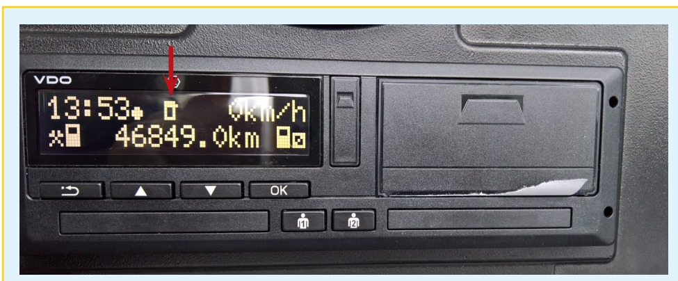
Fot. 22. Prawidłowe zalogowanie karty kontrolnej – zmiana trybu pracy na „kontrola”.
