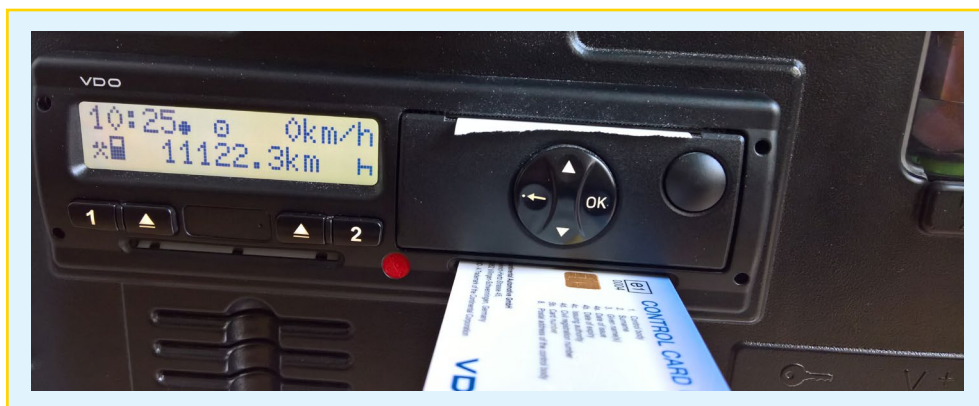
● Fot. 14. Wprowadzenie karty kontrolnej do slotu nr 2 – starszy model urządzenia VDO bez szuflady.
