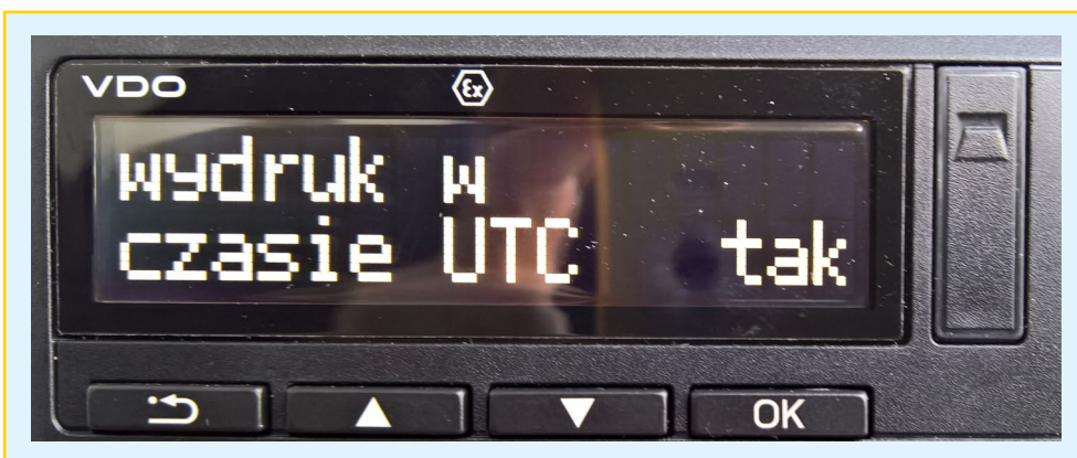
Fot. 7. Wybór czasu UTC lub lokalnego, w którym ma być wykonany wydruk.
