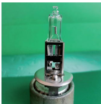
Fot. 10. Oznaczenie: H1. Zastosowanie: drogowe, mijania, przeciwmgłowe.
