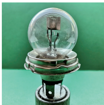
Fot. 9. Oznaczenie: BILUX. Zastosowanie: drogowe, mijania.
