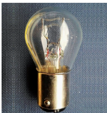
Fot. 15. Oznaczenie: P21W, PY21W. Zastosowanie: stop, kierunkowskaz, tylne przeciwmgłowe, cofania.
