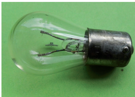
Fot. 22. Zerwany żarnik żarówki P21. Zdj. autorka.
