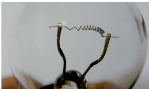
Fot. 31. Żarnik żarówki P21W wydłużony. Źródło: materiał udostępniony przez biegłego dr. inż. R. Janczura, prof. PK.
