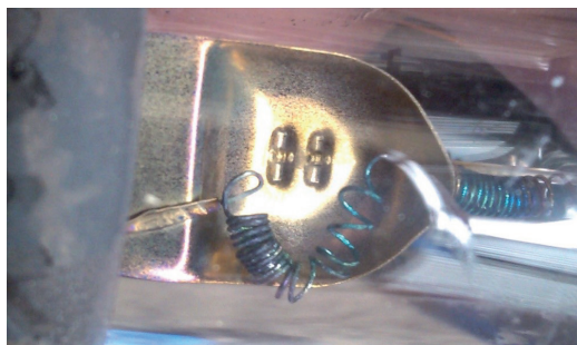
Fot. 32. Żarnik światła mijania H4 nadmiernie rozciągnięty. Źródło: materiał udostępniony przez biegłego dr. inż. R. Janczura, prof. PK.
