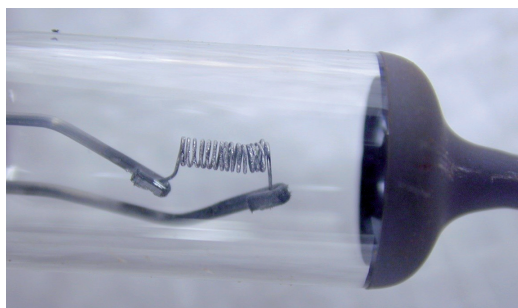
Fot. 30. Żarnik żarówki H7 częściowo ściśnięty. Źródło: materiał udostępniony przez biegłego dr. inż. R. Janczura, prof. PK.
