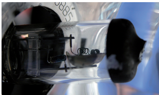
Fot. 33. Żarnik światła mijania H4 odkształcony i rozciągnięty. Źródło: materiał udostępniony przez biegłego dr. inż. R. Janczura, prof. PK.
