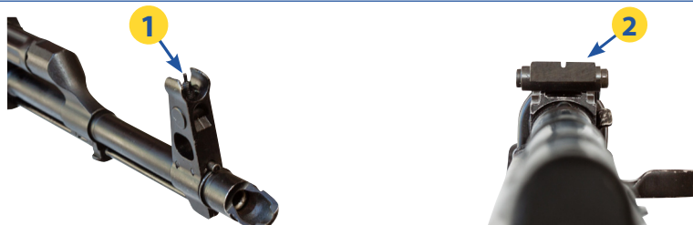
● Fot. 14 i 15. Przyrządy celownicze – nastawne przyrządy celownicze służą do wycelowania karabinka do celów znajdujących się na różnych odległościach (od 100 do 1000 m). Przyrządy celownicze typu otwartego składają się z muszki – 1 i nastawnego celownika (szczerbiny) – 2.
