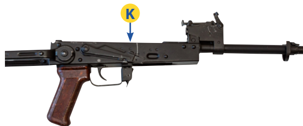
● Fot. 11. Komora zamkowa – element broni służący do połączenia wszystkich części i mechanizmów karabinka oraz do zaryglowania lufy zamkiem.
