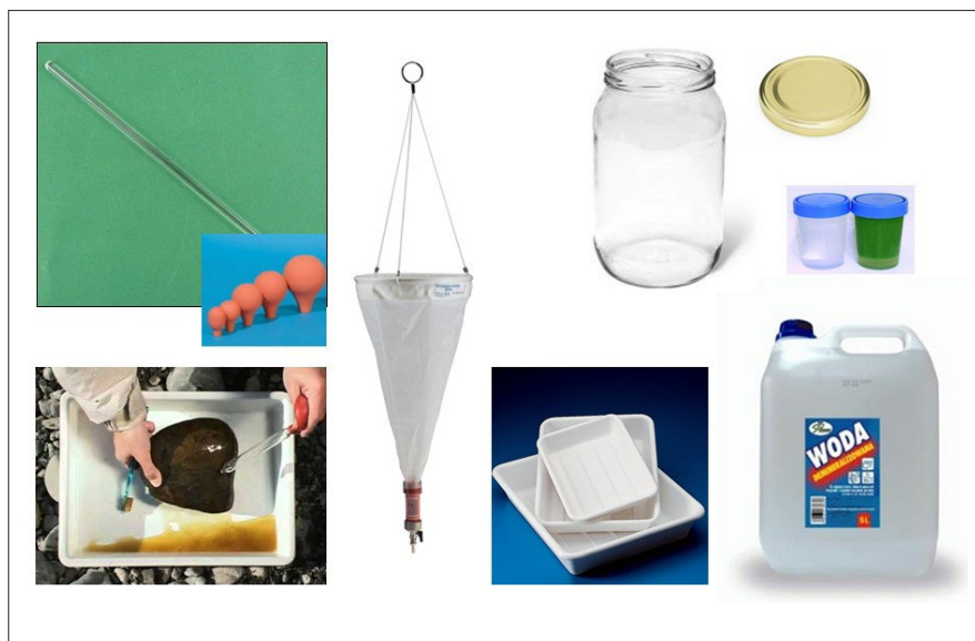
Ryc. 13. Podstawowe wyposażenie do zbierania okrzemkowych prób środowiskowych (zdz. J. Żelazna-Wieczorek).
