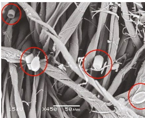
Ryc. 9. Obraz z elektronowego mikroskopu skaningowego – SEM (450-krotne powiększenie) ukazujący okrzemki zatrzymane w splocie tkaniny po wypłukaniu etanolem (Scott i in. 2014).
