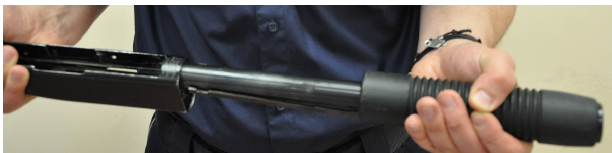
Wyjmij ramkę suwadła z komory zamkowej
