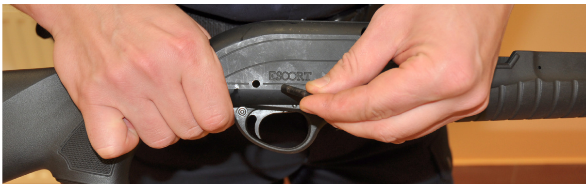
Wybij dwa kołki łączące w celu odłączenia mechanizmu uderzeniowo-spustowego od komory zamkowej
