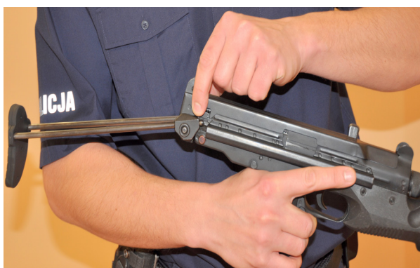
Przesuń zatrzask pokrywy do przodu i zdejmij pokrywę poprzez odchylenie tylnej części do góry
