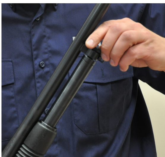
Odkręć śrubę przy łączniku rury magazynka
