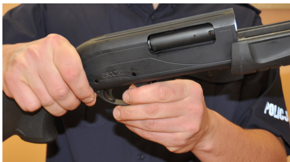
Odłącz mechanizm spustowo-uderzeniowy
