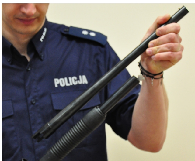
Wysuń lufę do przodu i oddziel ją od komory zamkowej
