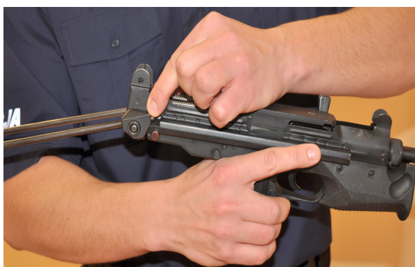
Wyjmij zatrzask pokrywy razem ze sprężynami powrotnymi
