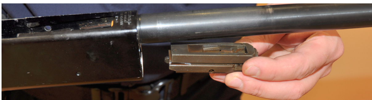
Wyjmij zamek przez okno osadzenia lufy
