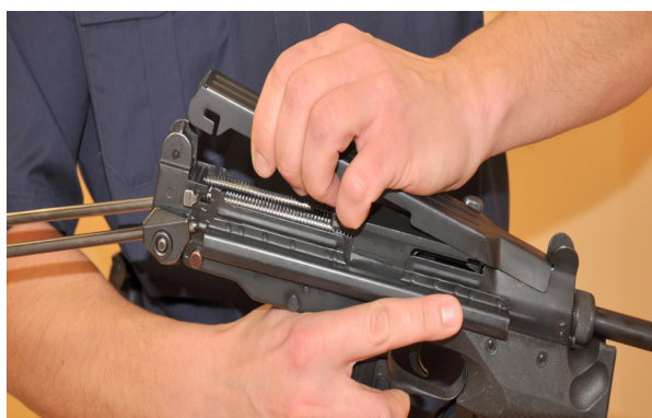
Przesuń zatrzask pokrywy do przodu i zdejmij pokrywę poprzez odchylenie tylnej części do góry
