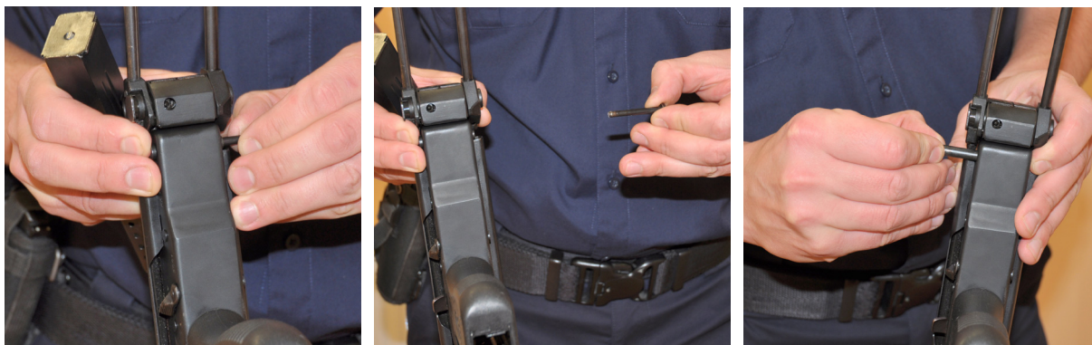
Wymij łącznik – sworzeń (trzpień) i tuleję, łączące chwyt z komorą zamkową
