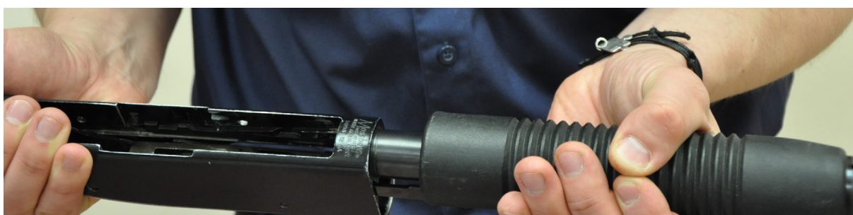
Odłącz rękojeść przeładowania z listwami
