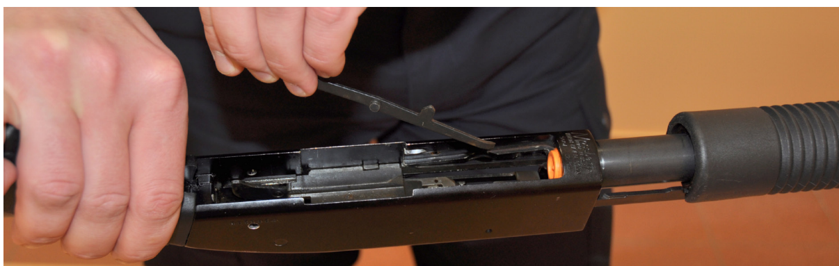
Wyjmij rozdzielacz z komory zamkowej
