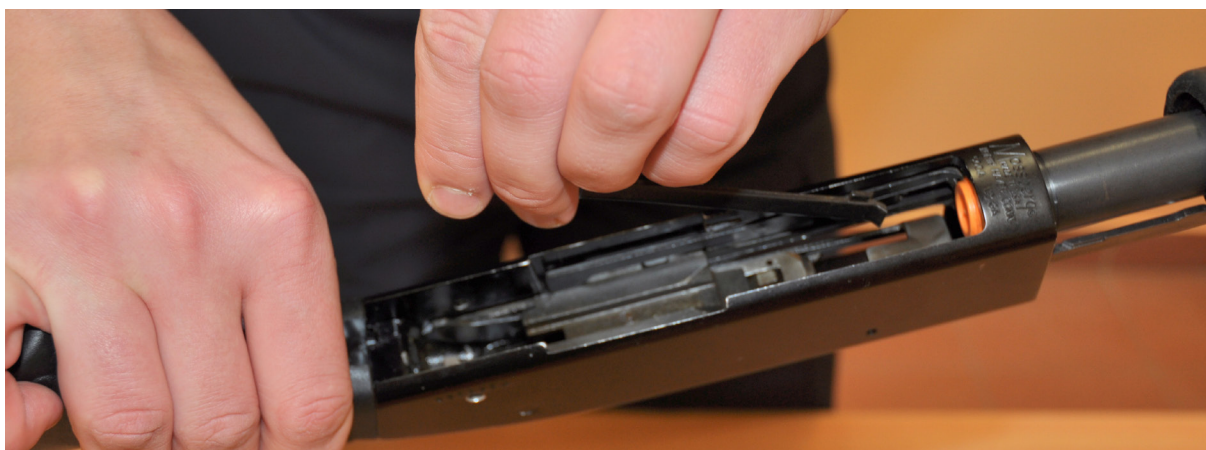
Wyjmij ustalacz z komory zamkowej
