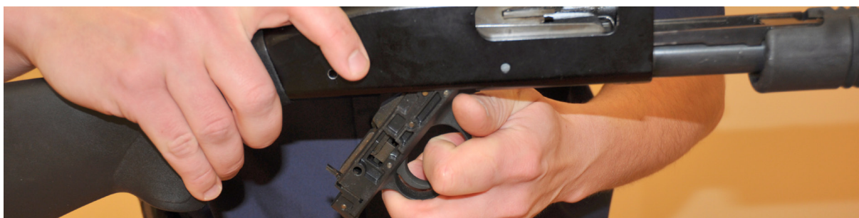
Oddziel mechanizm uderzeniowo-spustowy od komory zamkowej
