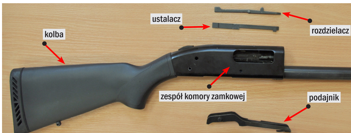
Zespół komory zamkowej i kolby (na ten zespół składają się elementy wskazane strzałką)
