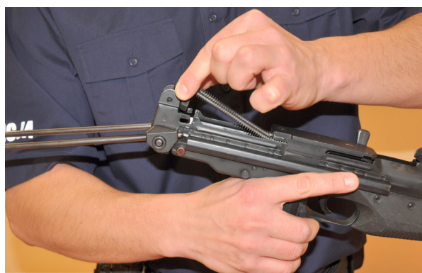
Przesuń zatrzask pokrywy do przodu i zdejmij pokrywę poprzez odchylenie tylnej części do góry
