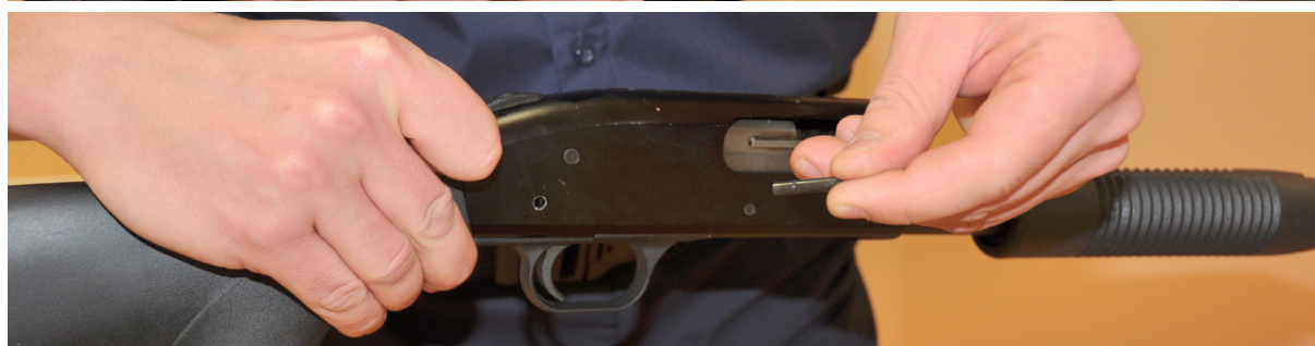
Wybij i wyjmij sworzeń łączący
