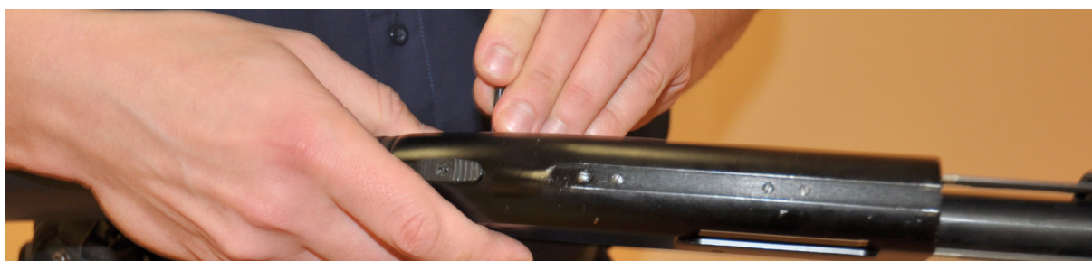
Odkręć śrubę przy łączniku rury magazynka
